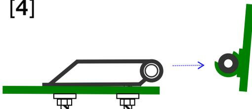
Setzen Sie nun das Scharnier an die POM-Lagerhülse und stecken Sie die Schraube seitlich durch.
