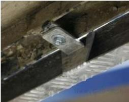
Setzen Sie den 2See von unten an und verwenden Sie die vorhandenen Befestigungspunkte. Schrauben sollten immer leicht eingefettet werden.
