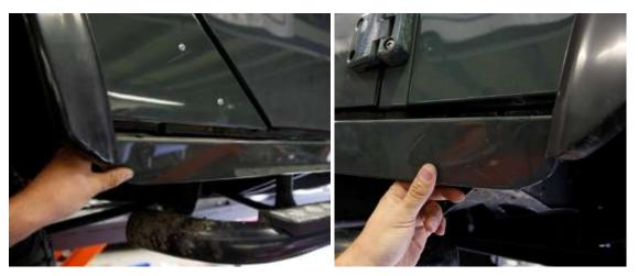
Entfernen Sie zunächst die bestehenden Blenden unterhalb der Türen. Die Schrauben sind von unten und im Radlauf zugänlich
