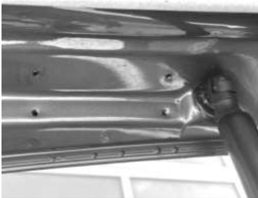
Halter oben links angezeichnet / gekörnt
